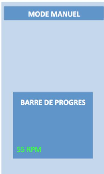
Le **Mode manuel** permet de réaliser une séquence complète de jar test sans passer par une séquence programmée (flash mix, floculation et décantation). L'opérateur contrôle la vitesse de chaque étape et le temps qu'il veut accorder à chacune d'elles.
