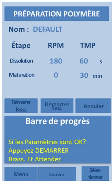
*À partir la fenêtre d'une séquence, on peut sélectionner une nouvelle séquence en appuyant sur **Sélectionner**. Par contre, il n'est pas possible de sélectionner autre séquence pendant qu'une séquence est en cours d'exécution; appuyer d'abord sur **Annuler**, pour interrompre la séquence en cours.*
