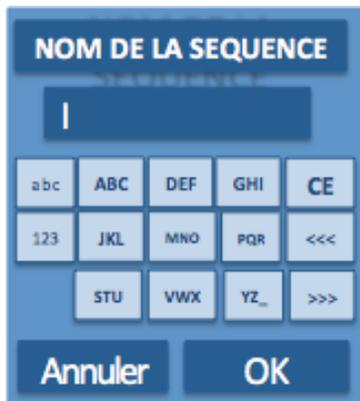
Le clavier alphanumérique sert à entrer des lettres, des chiffres et des symboles pour la programmation de l'instrument. Les icônes situées à droite et à gauche de l'écran sont décrites dans le Tableau 5.1.
